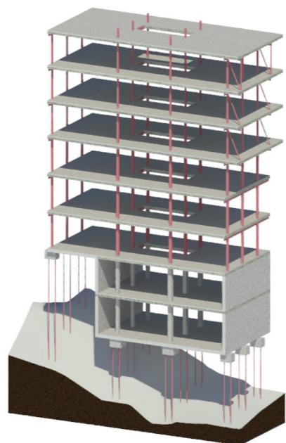
Typisk utsnitt av konstruksjonen i sengebygget
