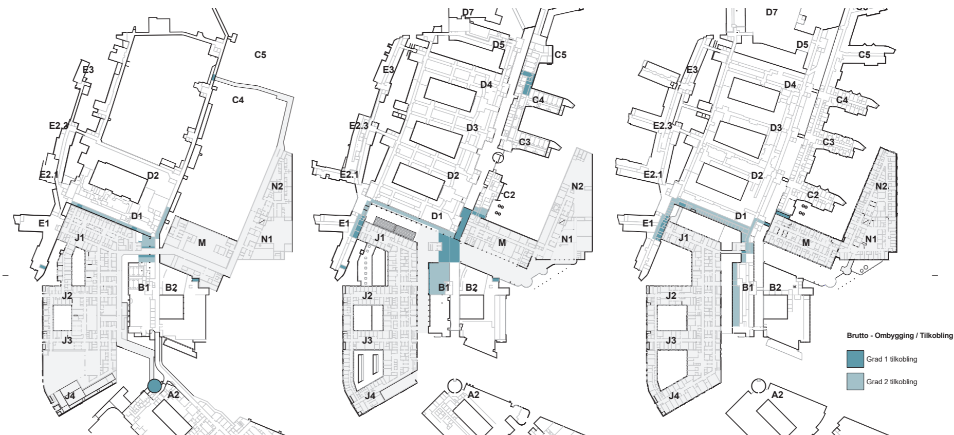
Figur 5.57 - Tilkoblinger mellom nye og eksisterende bygg
