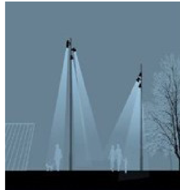
Figur 6.42 - Multimaster med 3-4 armaturer ulik optikk for å synliggjøre traséen til hovedinngang
