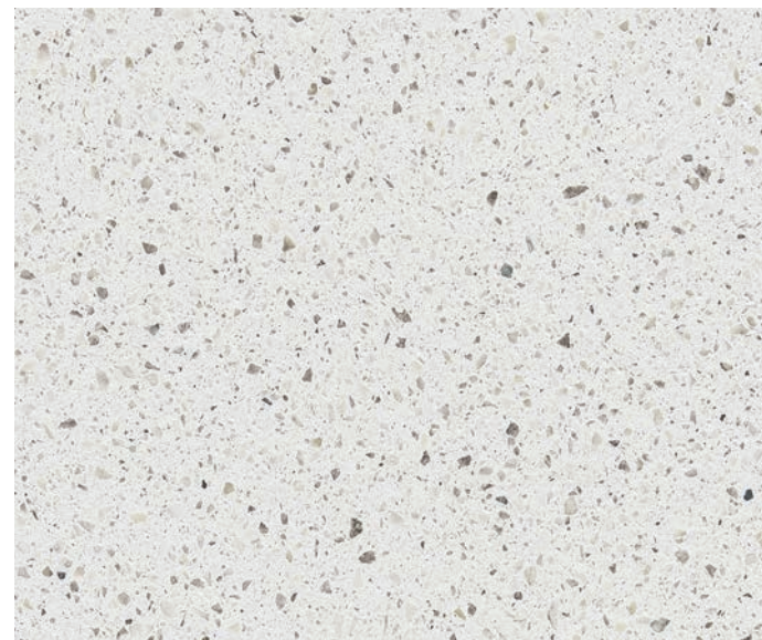
Figur 5.16 Lys betong blir hovedmaterialet på fasadens pre-fab-elementer.
