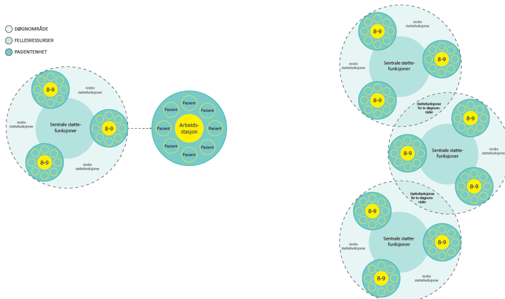
Figur 7 Utkast til prinsippdiagram for døgnområder. Det viser et døgnområde på 27 senger som kan underdeles i pasientenheter på 9 senger. Flere døgnområder kan henge sammen om dette er mulig med hensyn til utbygningsløsning
