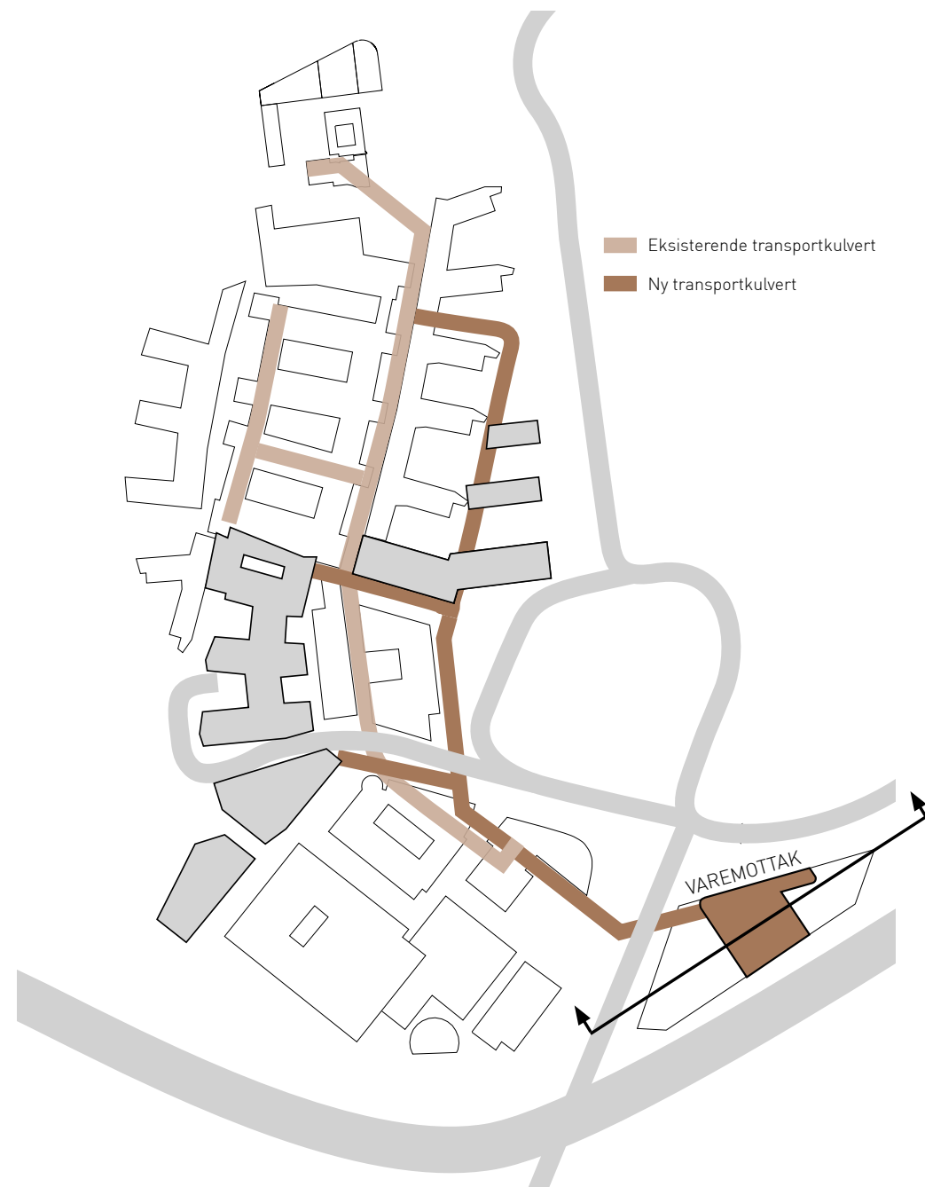
Figur 6.28 Distribusjon varer i nybygg og eksisterende Rikshospital.
