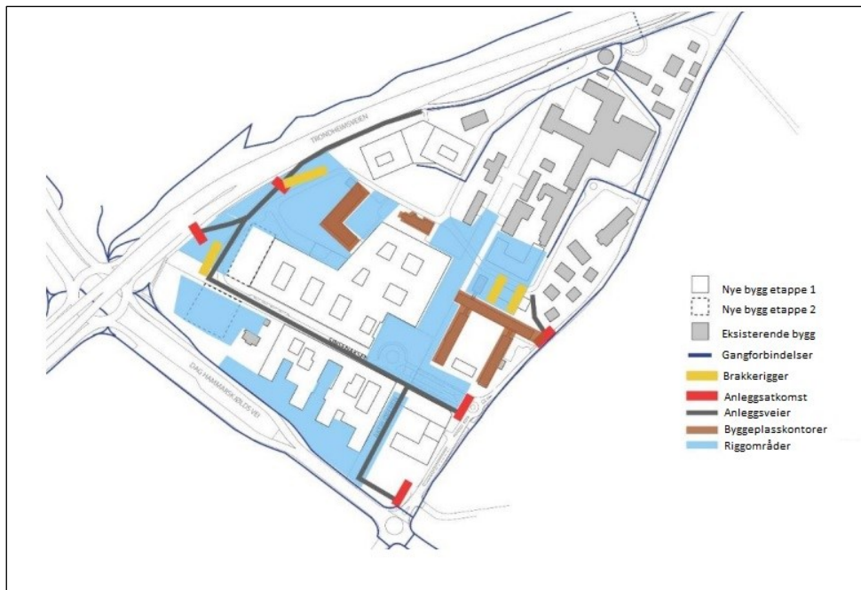
Figur 37. Rigg og anleggsområde for Nye Aker
